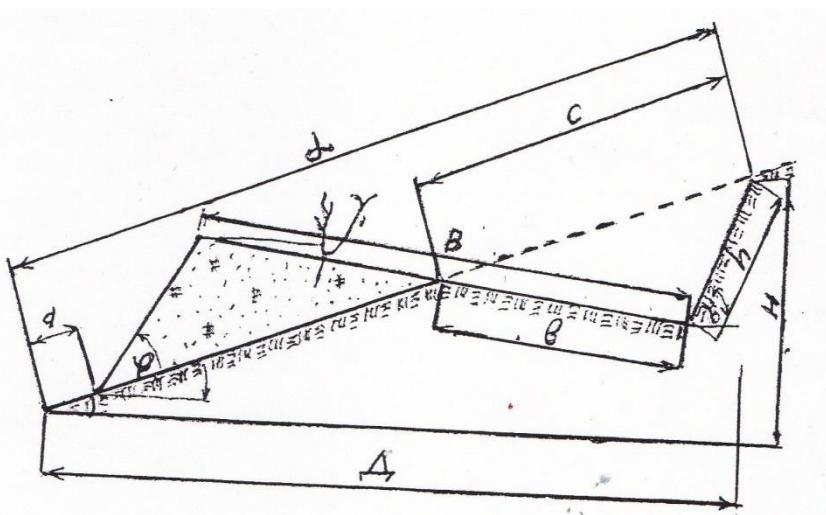
**Схема 5.3.1-Поперечное сечение ступенчатой террасы**
